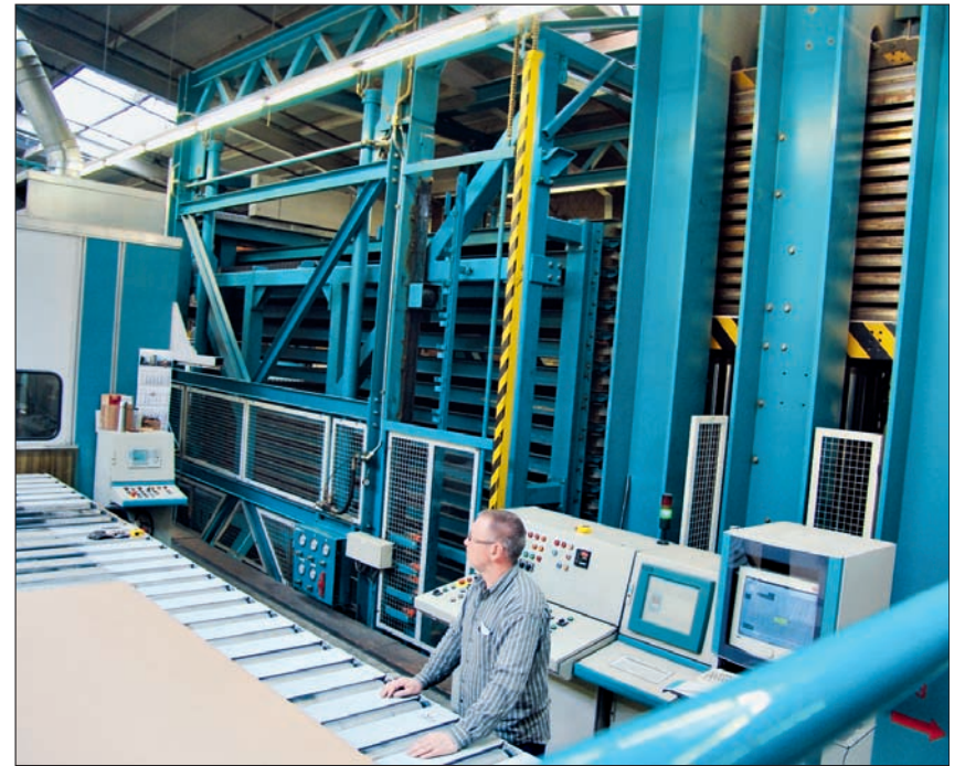
Mit einem Mix aus technisch-flexibler Fertigung in Deutschland und Produktionsanlagen in Osteuropa hat die Firma SWL die schwierigen letzten Jahre überlebt. Im Bild die 14-Etagen-Pressen am Stammsitz Langenberg. Foto: Fischer (2013)
